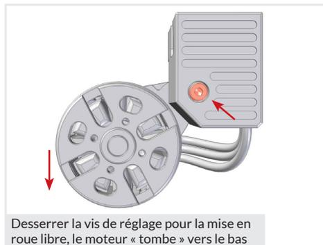
3. Si la distance est inférieure à 2-5 mm, desserrer d'un tour la vis de réglage pour la mise en roue libre (3). Il n'est pas nécessaire de dévisser complètement la vis.
