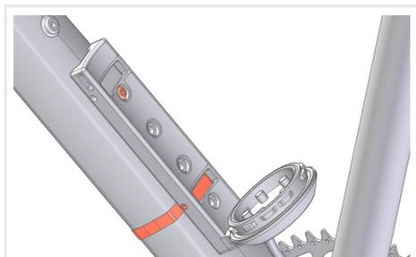
Fixation du support de batterie avec vis et bande d'acier
