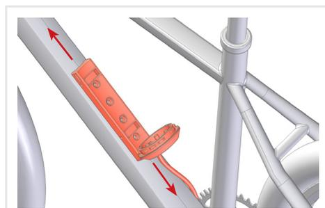
Support de batterie sur le tube diagonal
