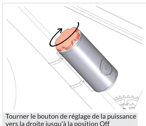
Tourner le bouton de réglage de la puissance vers la droite jusqu'à la position Off
